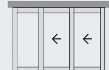
Dos hojas con lateral fijo 3 módulos Folha dupla com parte lateral fixa 3 módulos
