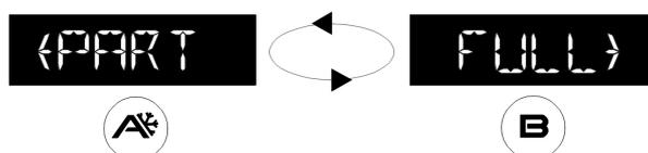
Premere il pulsante A per lanciare un set-up distanza (PART), oppure premere B per lanciare un set-up completo (FULL).
