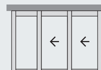
Vantail double avec élément latéral fixe 3 modules Zweiflügelig mit festem Seitenteil 3-Module
